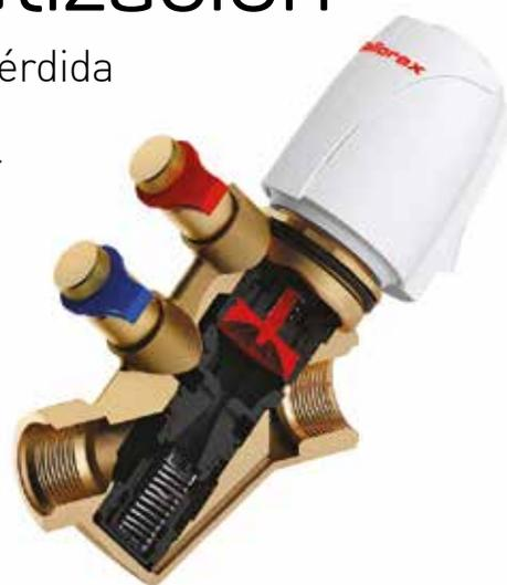
Con la inserción de una tobera Venturi, se consigue una válvula de regulación de paso fijo. Una de las ventajas que aporta es la lectura directa del caudal. El valor  $K_v$  de la tobera Venturi es constante y no cambia cuando se realiza el ajuste. El equilibrado es muy rápido. Este tipo de válvula asegura una muy buena estimación del
