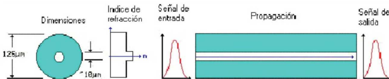
Propagación en una fibra óptica multimodo
